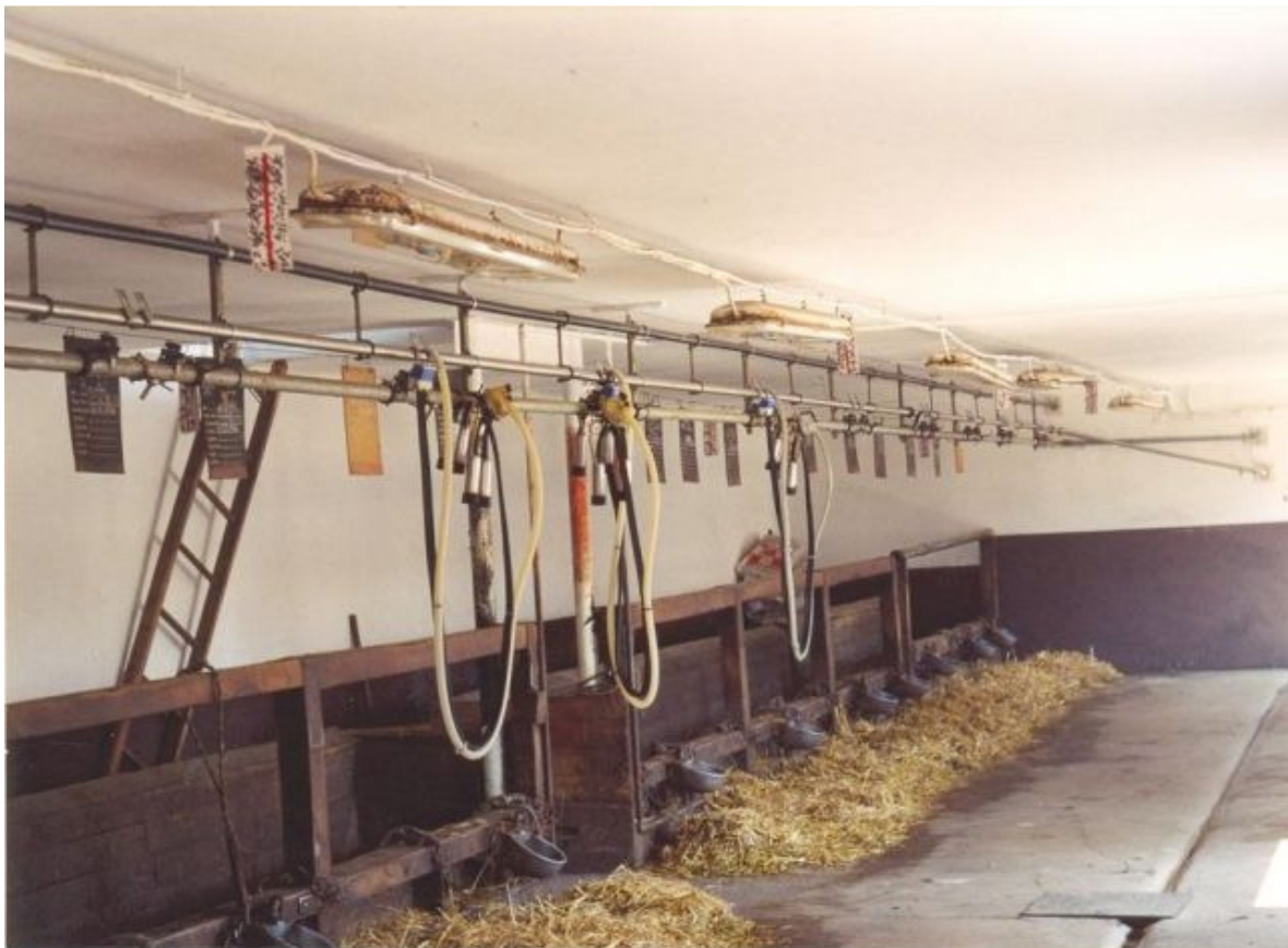
4. kép: A fejőistálló belső látképe. A fejesre előkészített 3 fejőkészüléket a felső vezetékekre kapcsolva láthatjuk.
