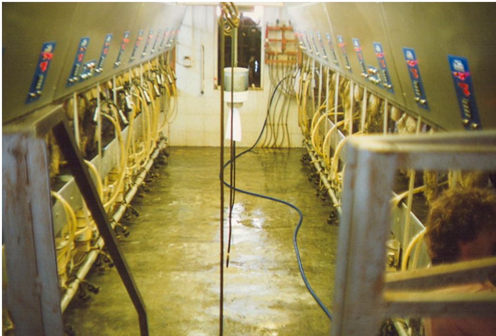
9. kép: A párhuzamos, 2x12 állásos rendszerű, gyorskieresztős fejőállás belső látképe
