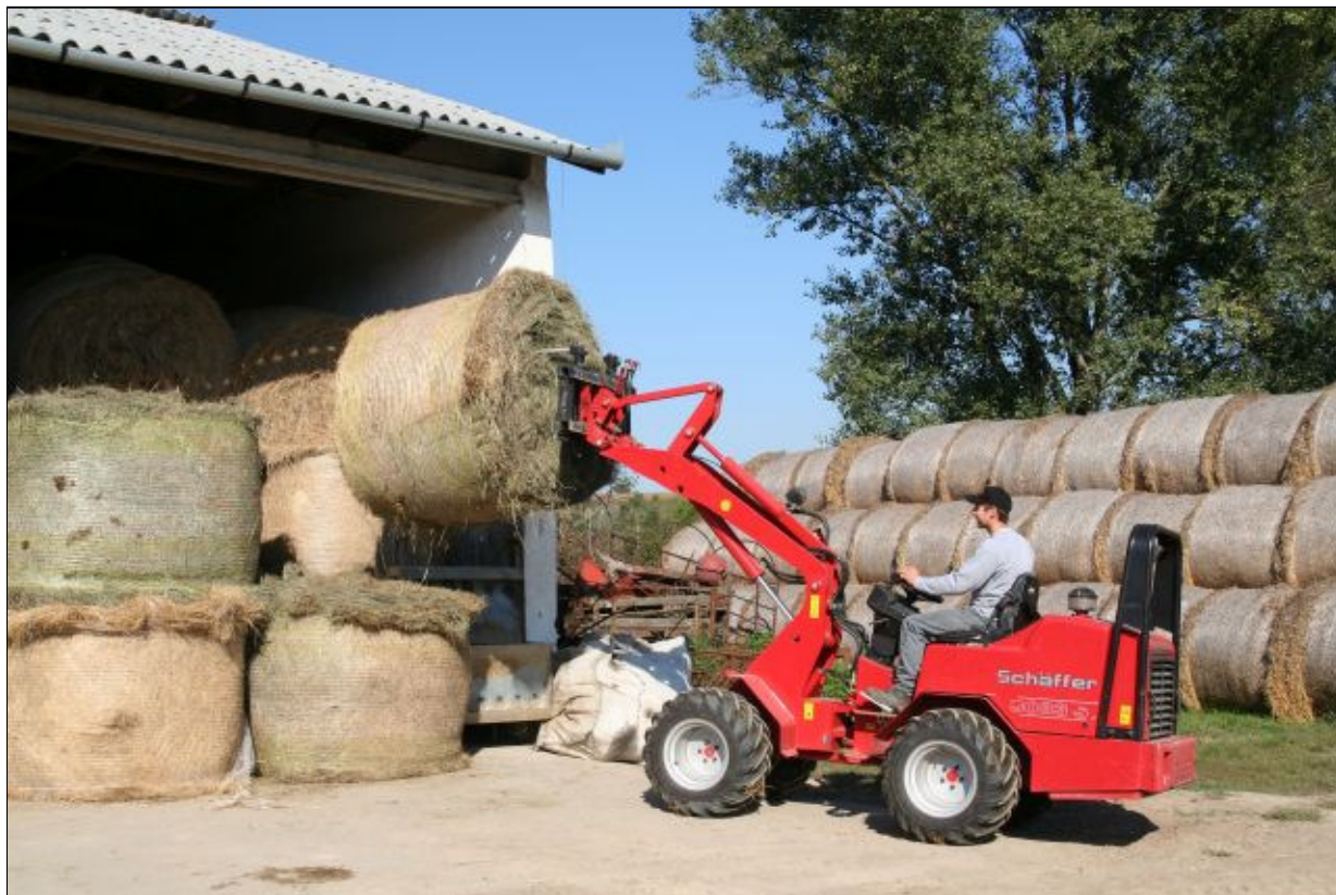
5. kép: Körbálát a kettős villával felszerelt csuklós rakodógép emeli ki a szénapajta alól. Ezután elszállítja az istállóba, és behelyezi azt a kör alakú etetőrácsba.
